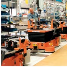
IPT®地面应用方式 车轴装配线上的AGV小车
