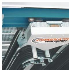
电动主电缆拖令小车,带磁性开关,用于回程到达限位停车
