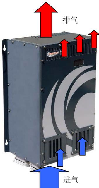
轨道电源柜需要充足的空气流通，以便获得充分冷却。确保轨道电源柜周围始终有自由空气流通，如果轨道电源柜安装在机柜内，还须定期检查过滤器是否被灰尘和油垢阻塞。
