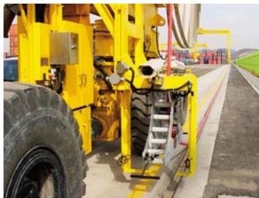
摄像头检测电缆沟，以确保电缆能够自由地放出和卷起。(选项)
