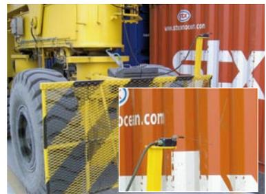
RTG大车前后部分的安全探头装置可以防止与摆放错误的集装箱意外碰撞。(选项)
