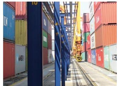
双侧供电的安全滑触线钢结构-滑触线单层布置。
