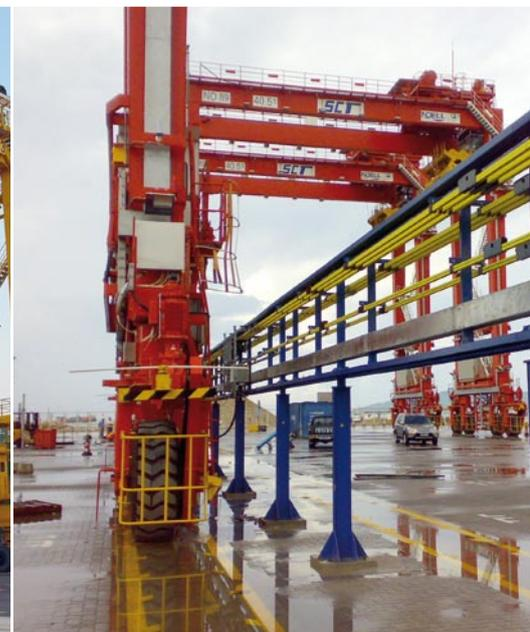
用电机驱动电缆卷盘系统或安全滑触线系统的轮胎龙门吊油改电解决方案—Conductix-Wampfler
