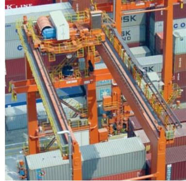
现代集装箱轮胎龙门吊(RTG)均配有柴油发电机，它将柴油燃料转化为电能，然后为RTG提供所需动力。
