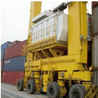
将一台RTG从柴油供电转变为由市电供电(E-RTG™)，指的是在堆场内关闭柴油发电机，直接使用滑触线、电机驱动电缆卷盘或其它供电方式为轮胎龙门吊提供动力。
