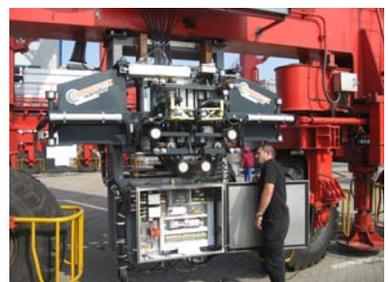
自动驶入集电器小车,全新的设计方案摒弃了“插/拔”的动作,缩短了RTG转场所需时间以及提高了操作安全性。自动小车安装在RTG的侧面。
