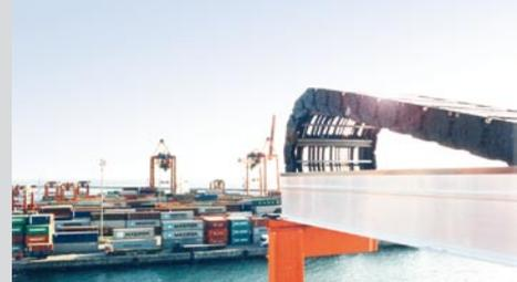
安装在堆料机上的Cobra系列拖链
