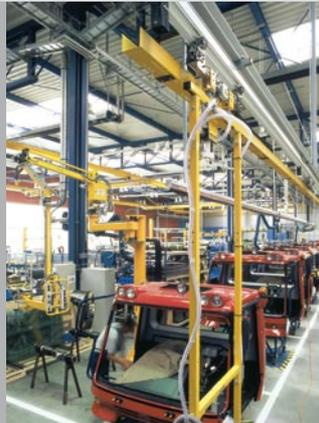
W<sup>4</sup>-airsolution 传输系统在商用车辆生产中的应用
