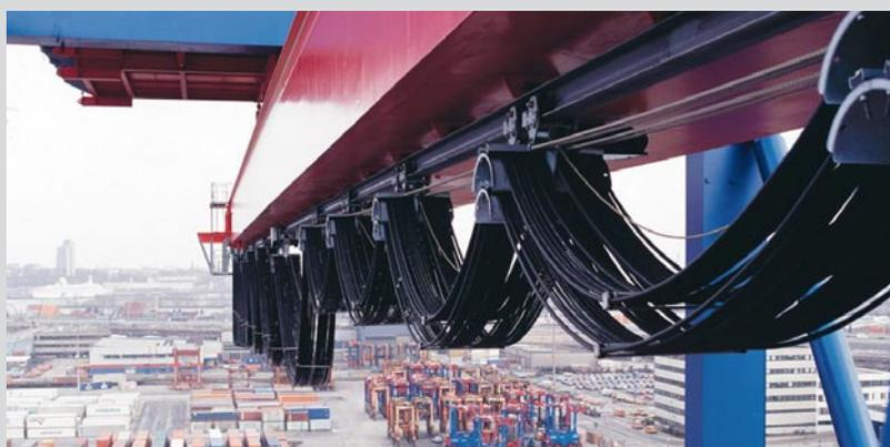
电机驱动的电缆拖令系统在集装箱起重机上的应用
